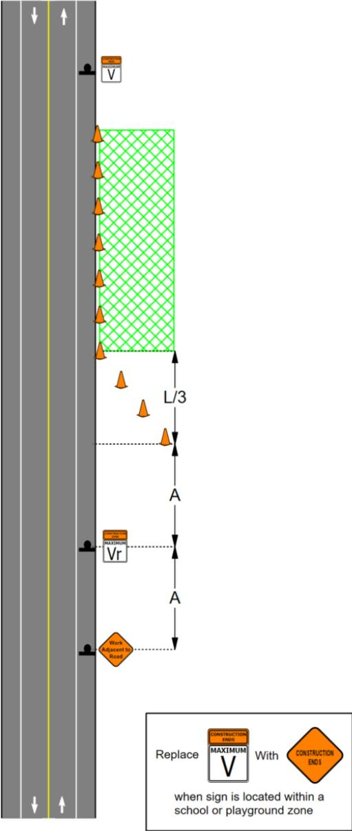
Drawing 4: Work on Edge of Roadway
